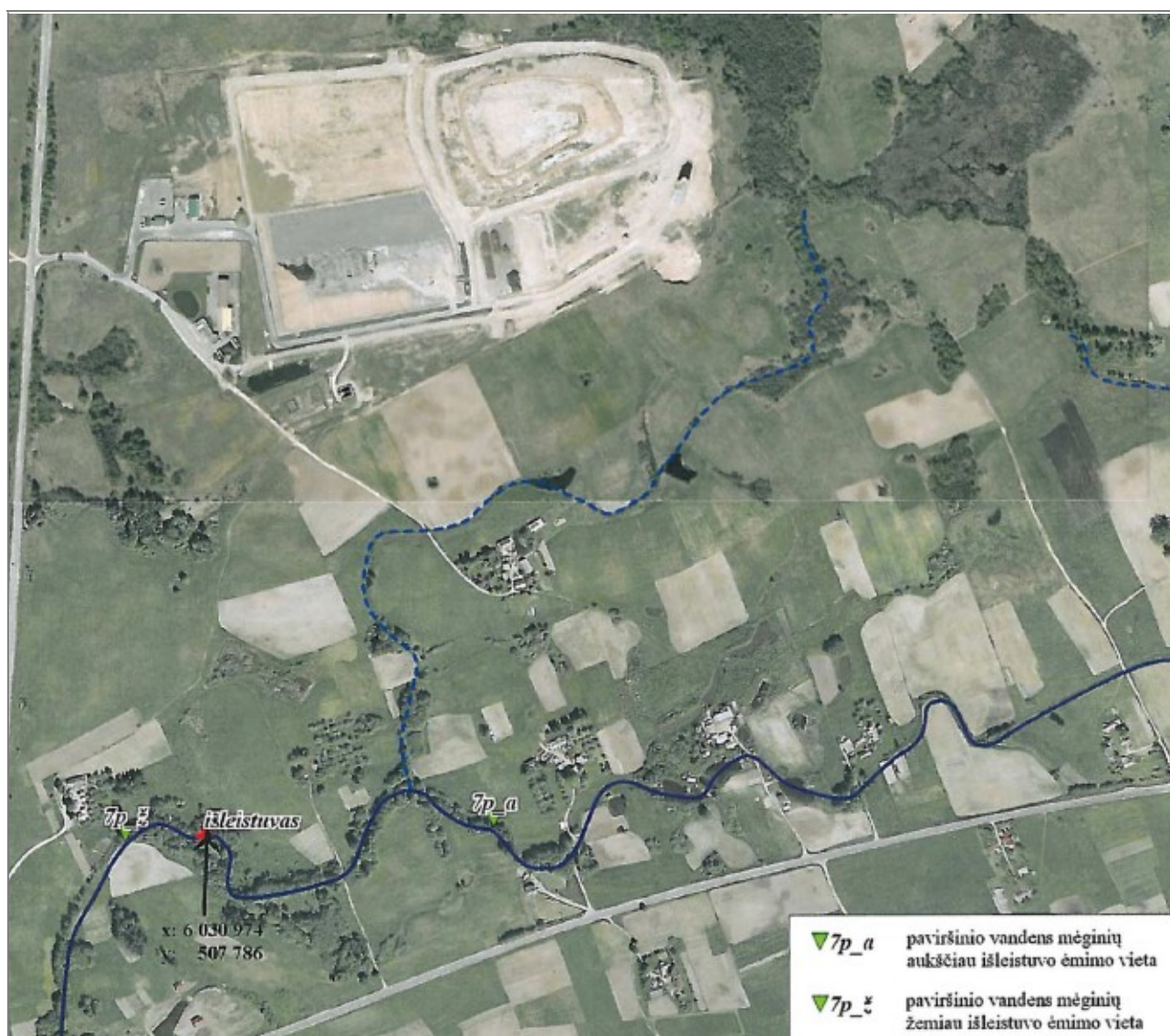
6 pav. Paviršinio vandens mėginių ėmimo schema (Alytaus regioninio sąvartyno, esančio Alytaus r. sav. Alovės sen., Takniškių k., Aplinkos monitoringo 2015 m. ataskaita)
